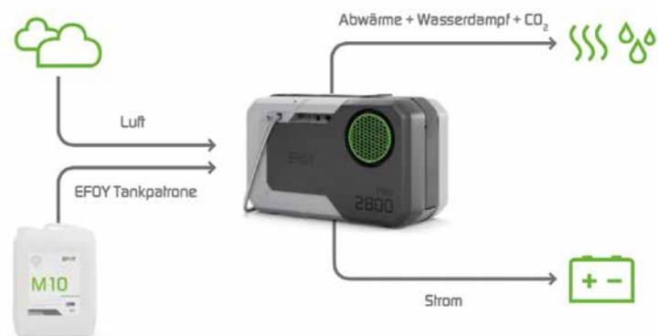
Abbildung 1: Funktionsprinzip DMFC-Brennstoffzelle ( SFC Energy AG, 2022)
