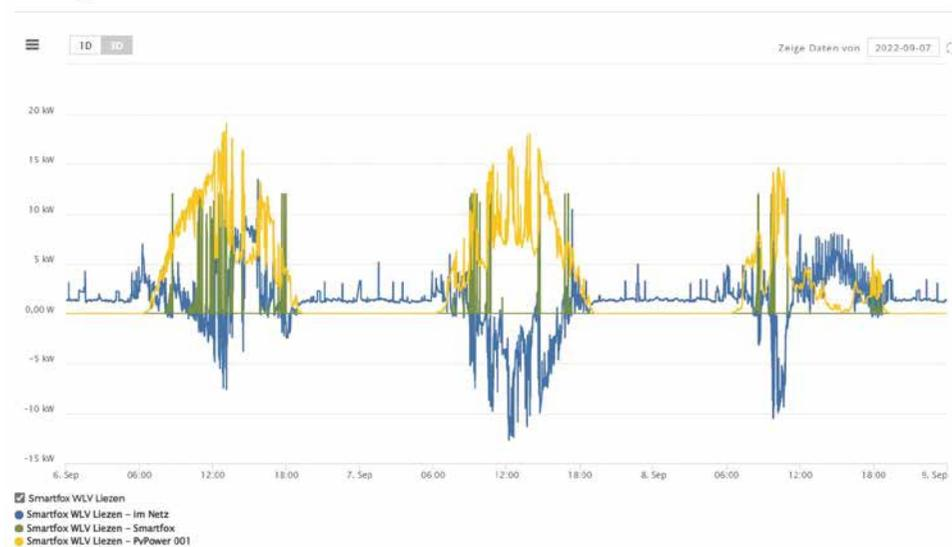
Abbildung 4: Beispiel für die Stromerzeugung mit Photovoltaik für den Eigenbedarf.
